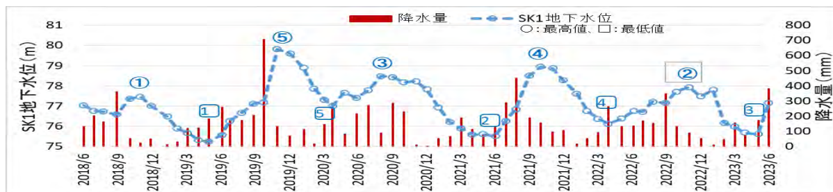
図 2. SK1 地下水位と降水量の経時変化
