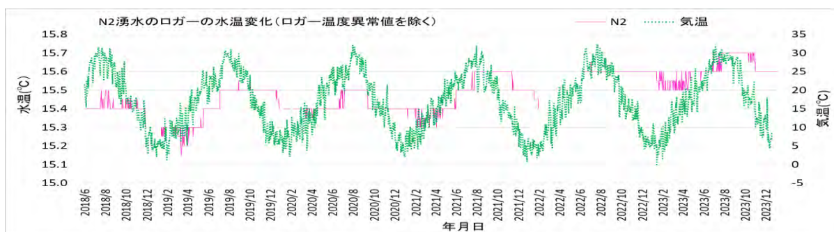
図 4. N2 の水温変化と気温変化（水温異常値を除く）
