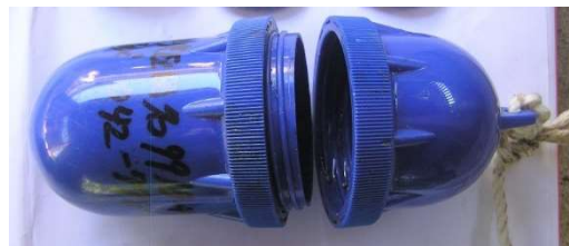
写真 5. 温度ロガーと防水カプセル
