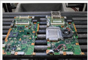
③ これは基盤です。基盤についている部品も取り外していきます。
