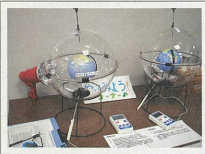
▲ 地球温暖化実験模型 空気中の二酸化炭素が多いと温度の上がり方はどうなるかな？
