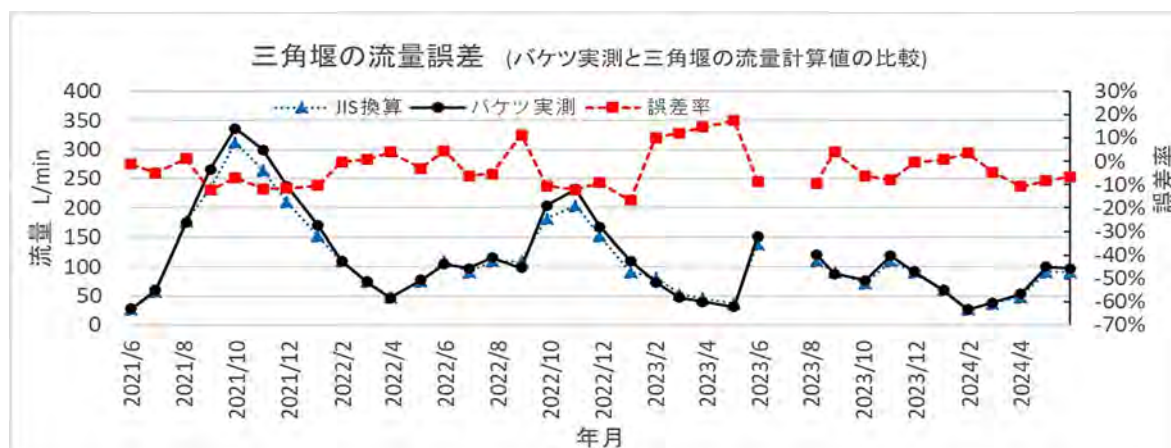
図 4. 三角堰の流量誤差率、バケツ実測と三角堰の流量計算 推移
