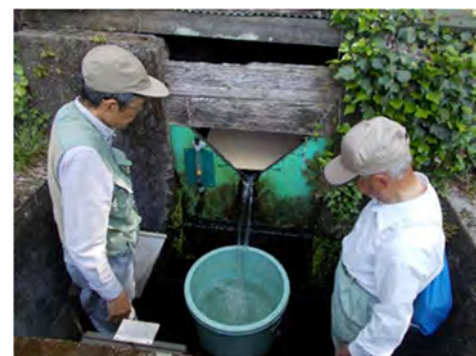
写真 2. N1D 三角堰から 80L のバケツに集水中
