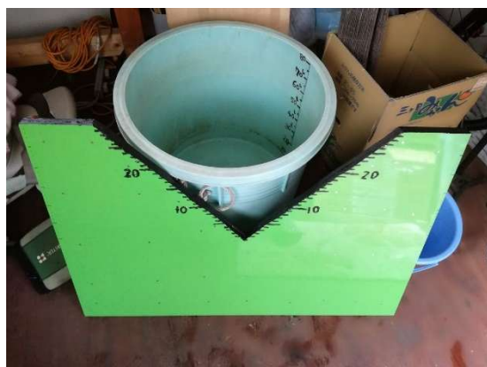
写真 2. 取付前三角堰と 80L のバケツ
